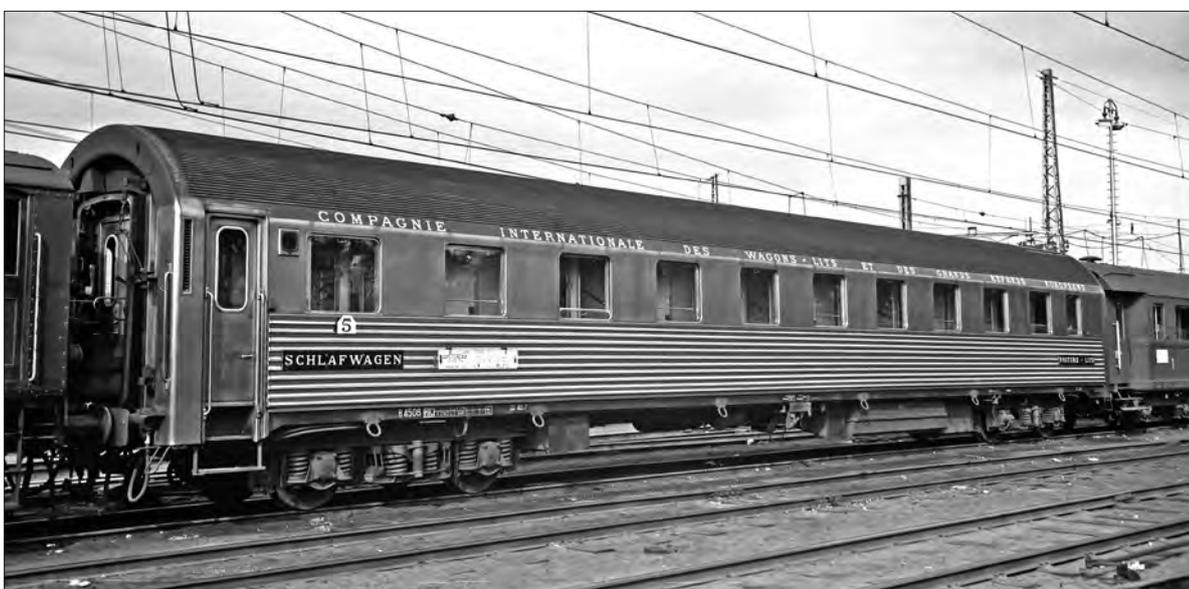
Der Nachkriegswagen INOX WL 4506 Type P der CIWL in Amsterdam CS am 31.5.1957 mit Zuglaufschild für den Holland-Italien-Express. Der Wagen wurde 1955 bei Nivelles gebaut und besaß ursprünglich 20 ineinander verschachtelte Einzelabteile und nur einen Einstieg pro Seite.
