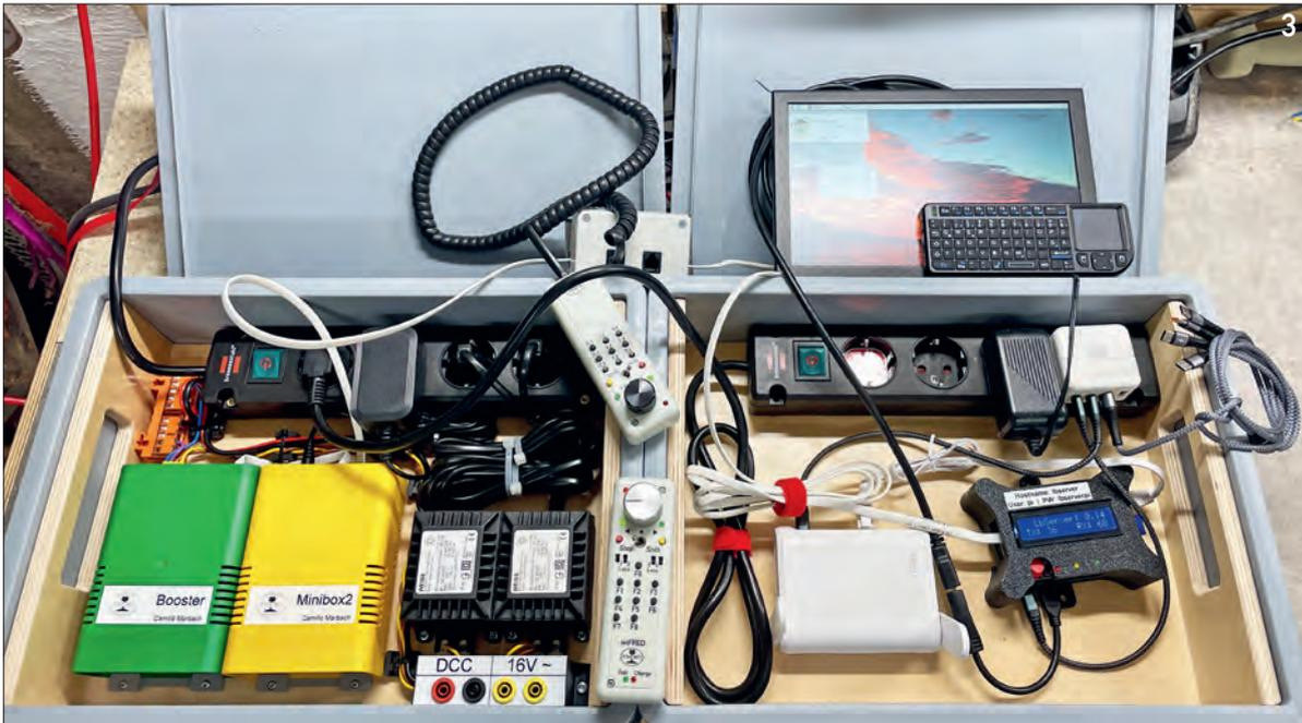
Aufbau aus MiniBox2, PiLocoBuffer, ext. WiFi-Router, Monitor und wiFRED (Konfiguration 2)
