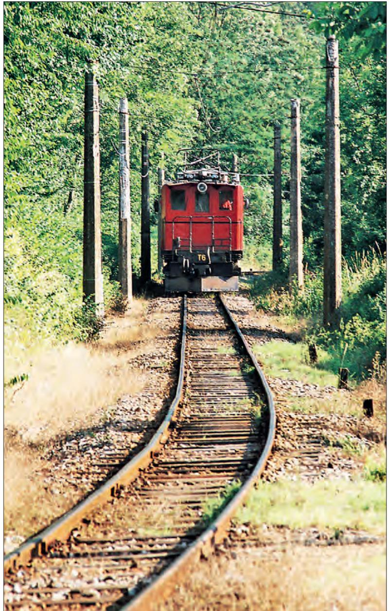
Oberleitung wie aus der Zeit der Elektrifizierung um 1910: Betonmasten auf beiden Seiten
