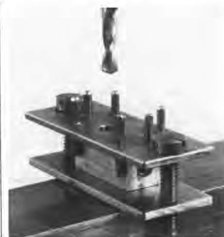
Abb. 17: Die Bohrlehre von Abbildung 16 im Gebrauch
