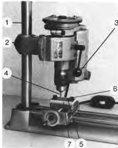
Abb. 13: Kleindrehbank, zur Kreuztischbohrmaschine umgerüstet: 1 – Vertikalbohrsäule, 2 – Klemmkopf, 3 – Handgriff, 4 – Zentrierbohrer, 5 – Werkstück, 6 – Befestigungsschrauben, 7 – Holzunterlage
