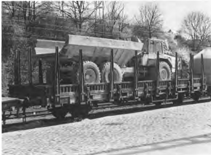
Abb. 2: Die Anliefe-rung von Bauma-schinen steht im Zu-sammenhang mit Großbaustellen, in diesem Fall mit ei-nem Fabrikneubau. Der Kbs 443 wird al-lerdings noch etwa 25 m nach links um-gesetzt werden, da-mit der Lkw auf die direkt an die Lade-straße anschließende Kopf-/Seitenrampe auffahren kann. (Melsungen, 5/88)
