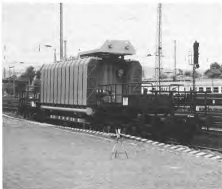
Abb. 3: Nicht etwa zu Ausstellungszwek-ken ist dieser Dienst-güterwagen der Bau-art Fwb 271 hier ab-gestellt. Sein schwe-res Ladegut, ein Transformator, wird mit Seilwinden (die Ladestraße ist mit Fahrdrabt über-spannt) auf einen entsprechend dimen-sionierten Tieflade-anhänger umgela-den, um gezogen und geschoben die letzten 1,5 km zu seinem neuen Standort zu-rückzulegen. (Bebra, 8/88)
