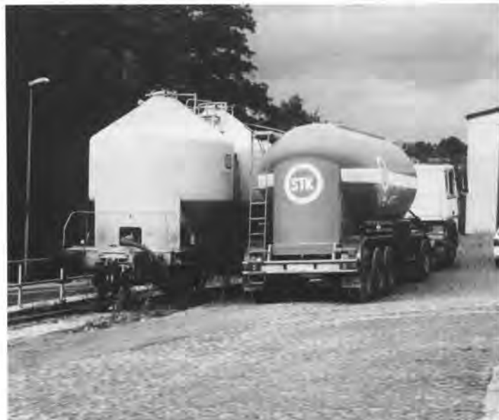
Abb. 4: In Melsungen entstand dieses Bild, das die Umladung von Zement aus ei-nem Ucs 909 in ein Straßensilofahrzeug zeigt. Normalerweise warten täglich 5–15 solcher Ucs-Wagen an der zweigleisig angeschlossenen Melsunger Ladestra-ße auf ihre Entla-dung. Auch hier ist eine Großbaustelle Anlaß für das Auf-tauchen solcher Spe-zialwagen: Die DB-Neubaustrecke, die in Nordhessen nahe-zu ausschließlich durch Tunnels oder über große Talbrük-ken führt. (Melsungen, 8/88)
