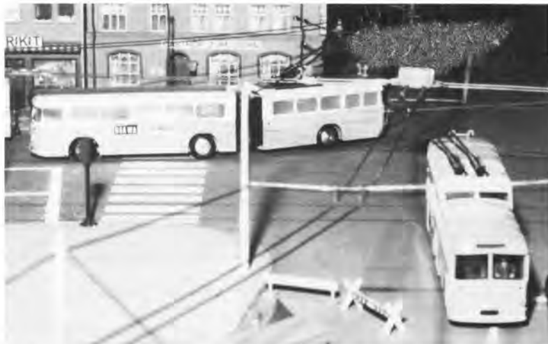
Abb. 4 (oben): Die Situation der Abb. 3 aus der Gegenrichtung gesehen. Der weiße Bus umfährt eine Baustelle. Deutlich zu erkennen sind die ausschwenkenden Stromabnehmer und die vom einen zum anderen Befestigungspunkt schnurgerade verlaufenden Fahrdrähte. Nicht zu sehen ist dagegen der Spurführungsmagnet, weder beim weißen Bus von vorne noch beim gelben Bus von der Seite!
