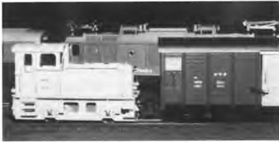
„Ganz in Weiß“ – das Modell einer Deutz-Diesellok, gebaut aus Polystyrol und Messingteilen von H. Wetekamp.
