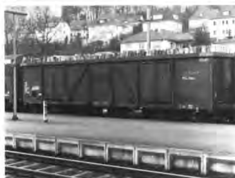
Abb. 4: Auf diesem Eaos der SNCB ist die Kranzbildung gut zu erkennen. Warum an der Stirnseite statt einzelner Hölzer Gitter aufgestellt sind, ist nicht bekannt.
