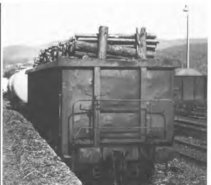
Abb. 10 (links) zeigt eine vollständige Ladung auf einem Eaos 052 der DB. Dieser modernste Wagentyp der E-Wagen bei der DB ist 15,7 m lang, verfügt über einen Stahlfußboden und Parabelfeder-Drehgestelle.
