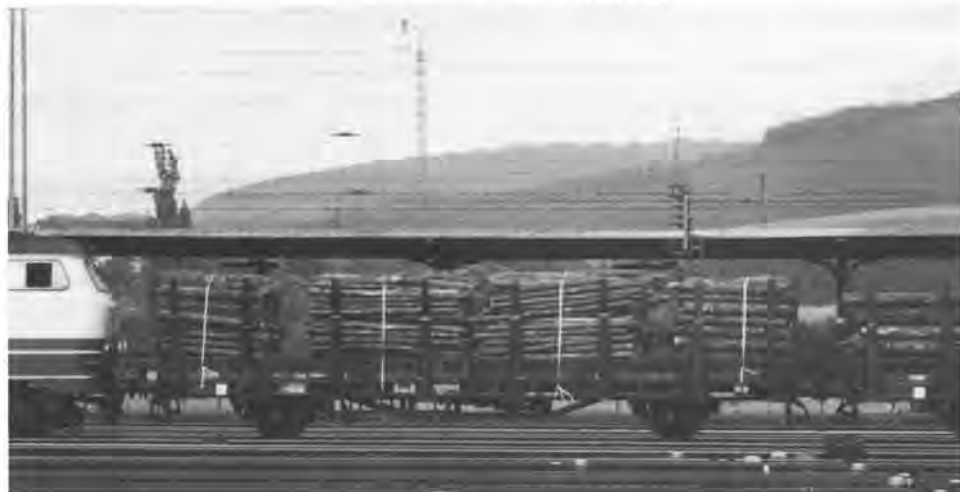
Abb. 2 und 3: Gut zu sehen ist hier, wieviel Laderaum die kurzen Längen tatsächlich freilassen. (Holzlängen in Abb. 2 etwa 2 m, in Abb. 3 etwa 3 m).
