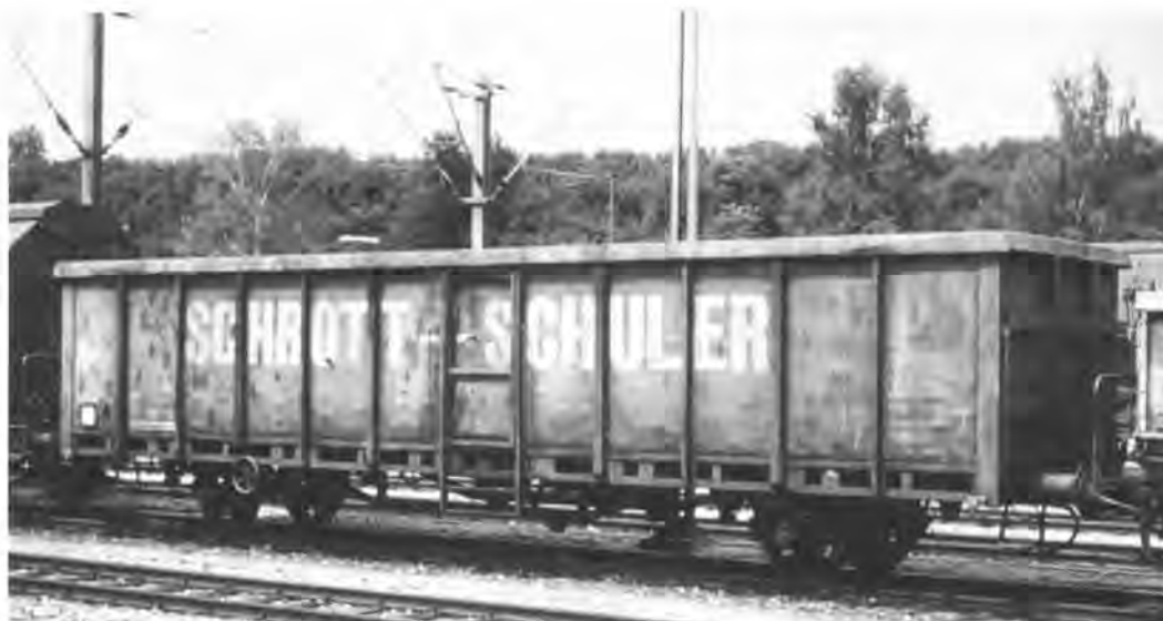
Abb. 1: Das Vorbild im (gebrauchten) Zustand des Jahres 1987. Im Vergleich zu Abb. 2 fällt auf, daß jede zweite Seitenwandung durch eine stärkere ersetzt wurde und auch die Tür eine waagrechte Versteifung erhielt. Die Dekoränderungen (Schrott-Schuler statt Schuler-Schrott u. a.) sind zusammen mit der nach 1980 ohnehin notwendigen Umbeschriftung und Neulackierung durchgeführt worden. (Foto: R. Ossig)
